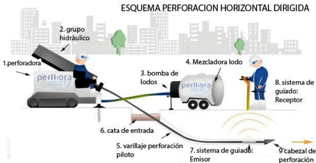
Figura N°17: Esquema Perforación Horizontal Dirigida
