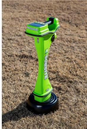
*Figura N°21: Localizador del cabezal de perforación.*
