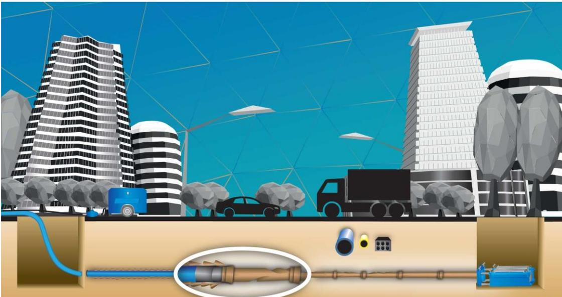
*Figura N°16. Esquema de Perforación Horizontal Dirigida*
