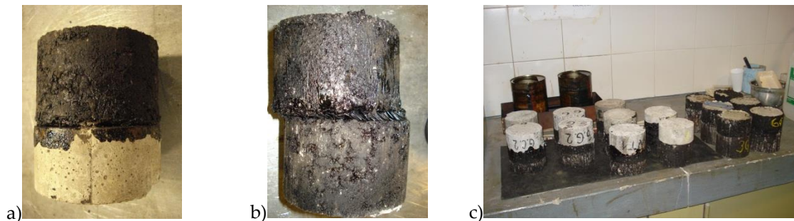
Figura 4. Conformado de probetas de diferente sustrato;
