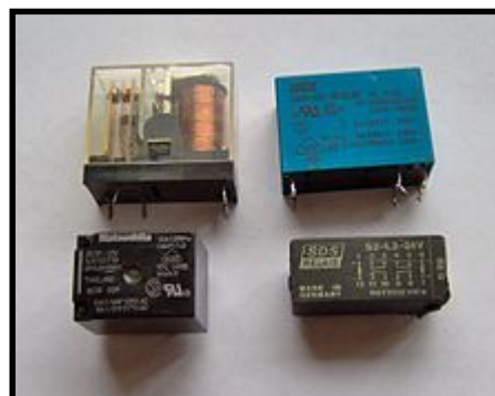
Fig. 37. Relés empleados en circuitos eléctricos
