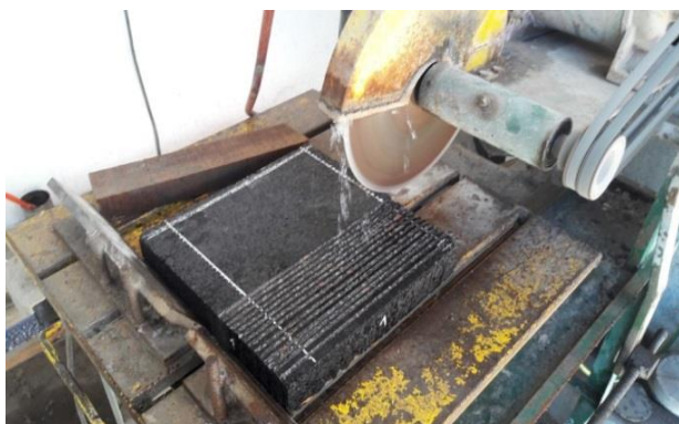
Figura 8. Simulación fresado probeta Caso 1
