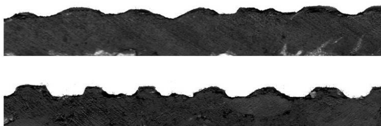
Figura 9. Perfil de fresado real versus simulación por aserrado
