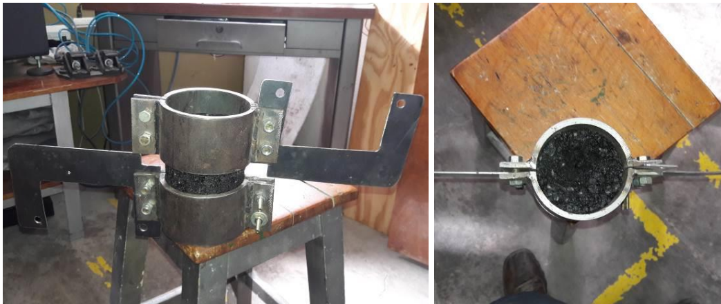
Figura 13. Imágenes en vista y planta de la probeta doble con mordazas
