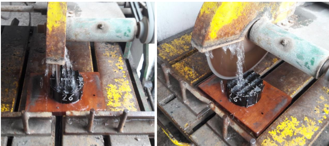
Figura 17. Aserrado de una probeta del Caso 5
