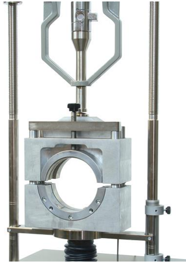
Figura 1. Máquina de ensayo de Leutner ( www.controls-group.com )
