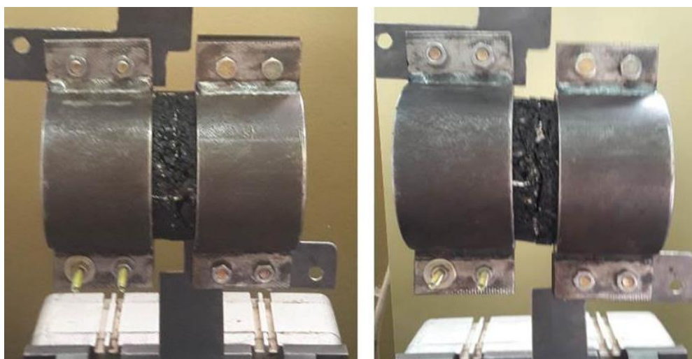
Figura 6. Deformación en zona central de la probeta doble durante el ensayo
