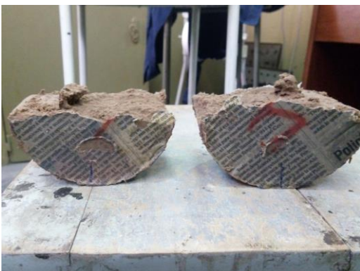
Figura 8. Probeta de Módulo Dinámico llevada hasta rotura.
