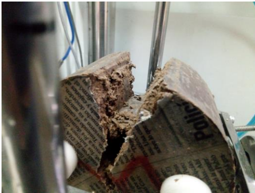
Figura 7. Probeta de Módulo Dinámico llevada hasta rotura.
