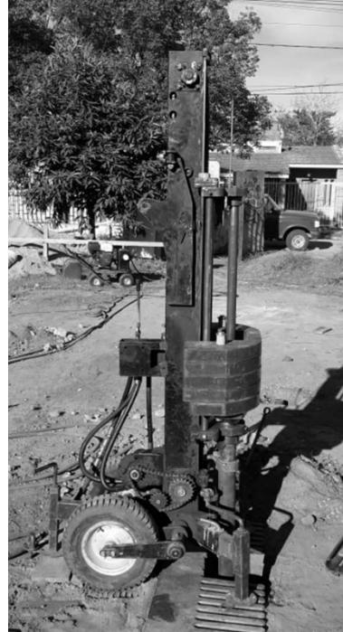
Figura 4: Hincadora dinámica – Micropilotea, muestras Clase 3 o 2. (Cortesía: GEF Geotecnia, Estructuras y Fundaciones)
