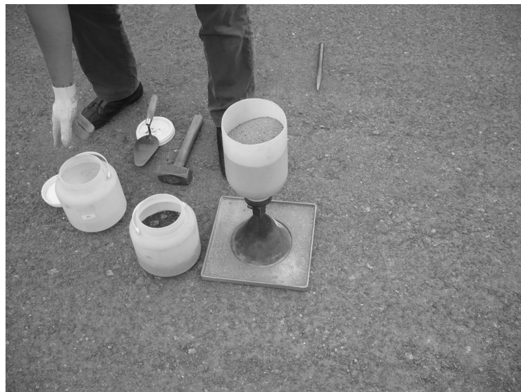
Figura 6: Equipo cono de arena para medir peso unitario in-situ. (Cortesía: CIGEF, UTN-FRC)
