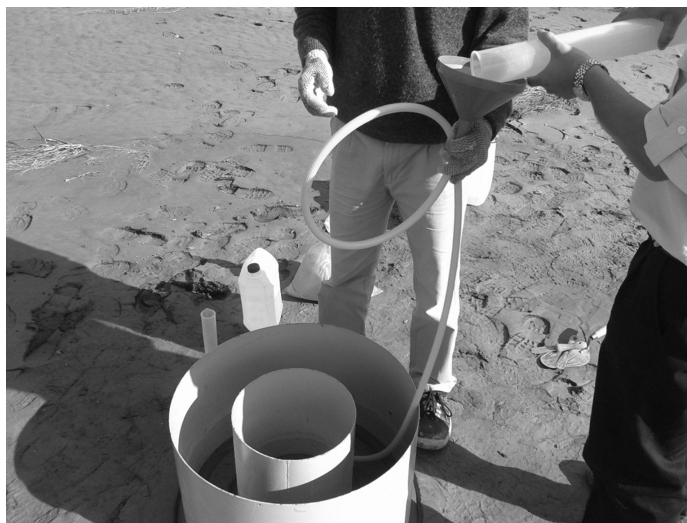
Figura 7: Equipo doble anillo para medir infiltración. (Cortesía: CIGEF, UTN-FRC)
