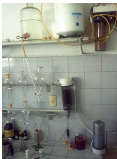
Figura 6: Equipo de laboratorio de remoción de arsénico
