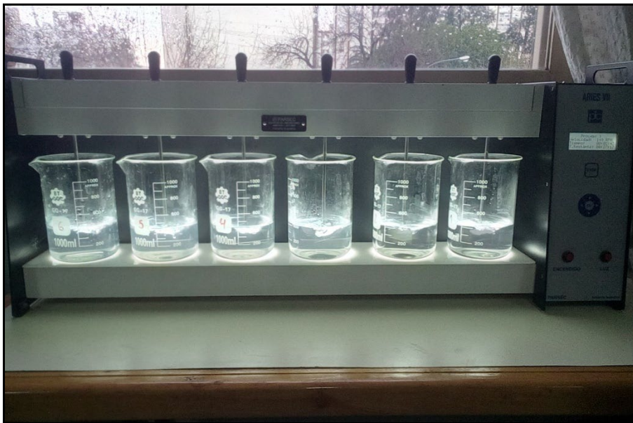
Figura 2: Sistema de reacción tipo Jar Test empleado en los experimentos de Coagulación-Floculación.
