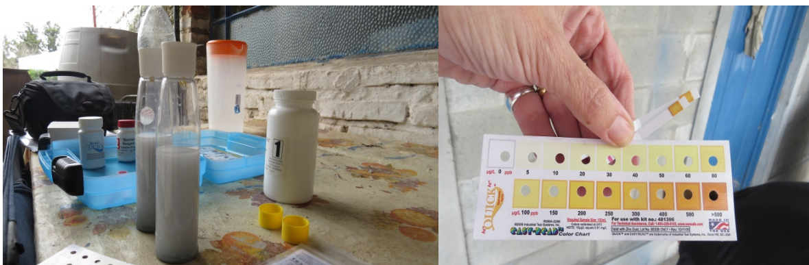
Figura 3: Botellas empleadas para el análisis de arsénico empleando el TQ, y escala de colores para determinación comparativa de la concentración de arsénico.
