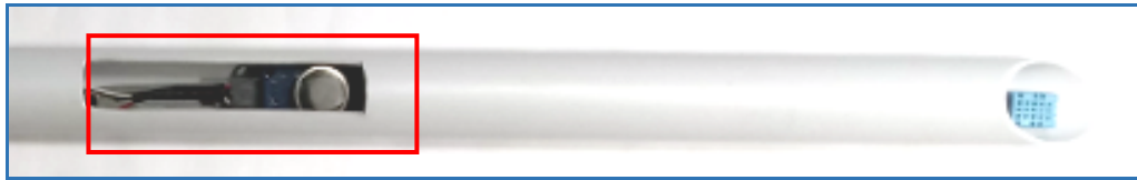
Fig. 32: Ubicación del sensor de CO2 en la lanza de toma de datos.
