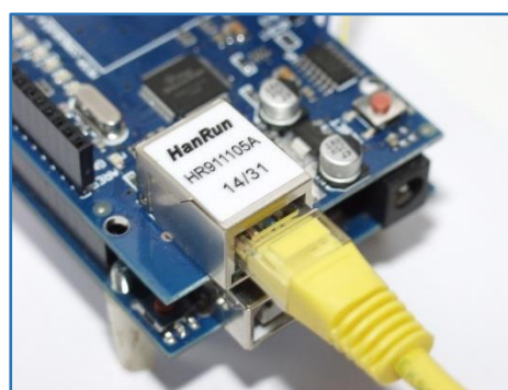
Fig. 19: Conector RJ45 para conexión de ethernet.
