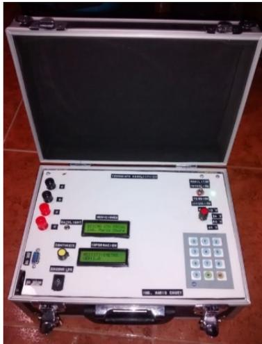
Fig 2. Tomógrafo eléctrico resistivo.
