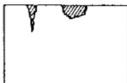
Figura 12: Corrosión por picaduras.
