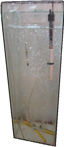
Figura 33: Torre de humidificación de aire.
