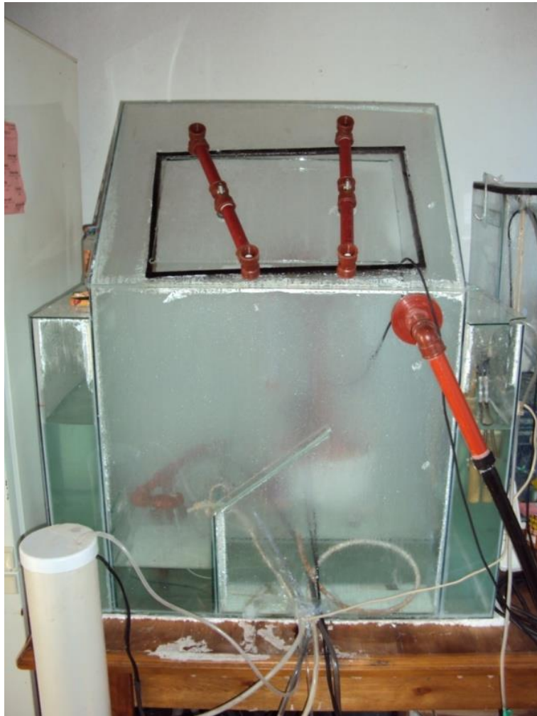
Figura 30: Cámara de Niebla Salina perteneciente al GIS.
