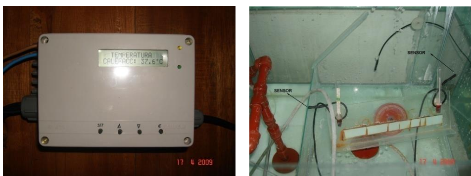
Figura 37: Controlador y sensores de temperatura.
