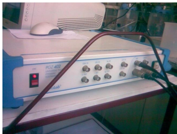
Figura 44: Potenciostato VOLTALAB PGZ 402 perteneciente al INTEMA.
