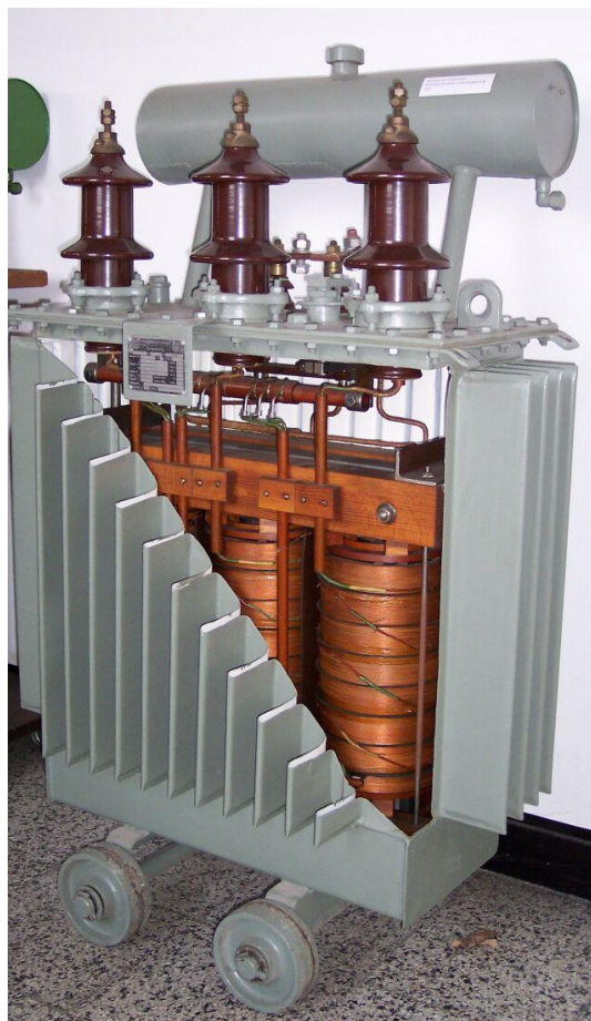
Imagen 4.1 – Transformador de distribución en corte – Imagen ilustrativa.
