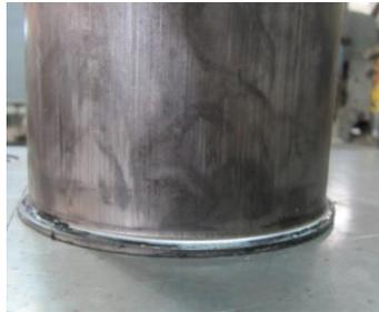
*Figura 46. Defectos de rayado superficial en pieza embutida.*
