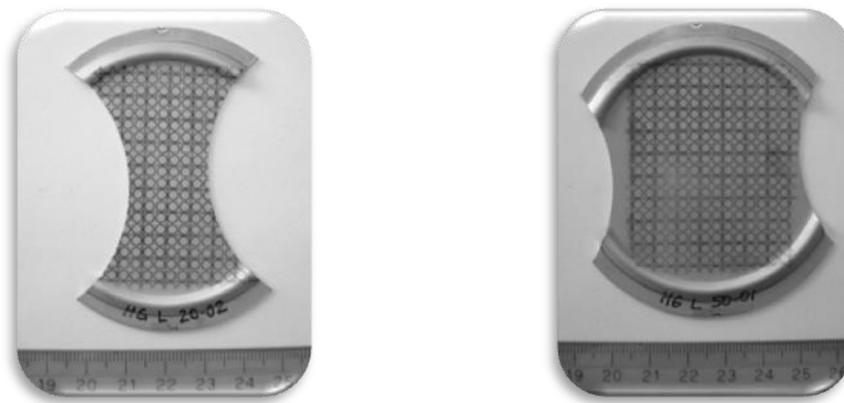
Figura 6. Entallas efectuadas sobre las probetas.
