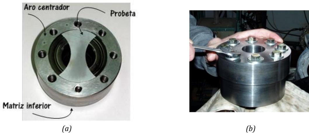
Figura 5. Secuencia para la obtención de la entalla; (a) Aro centrador, (b) Ajuste de los tornillos de la parte superior de la matriz.
