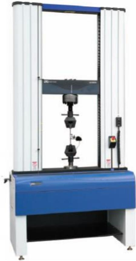
Figura 10. Máquina de ensayos Instron 3382.
