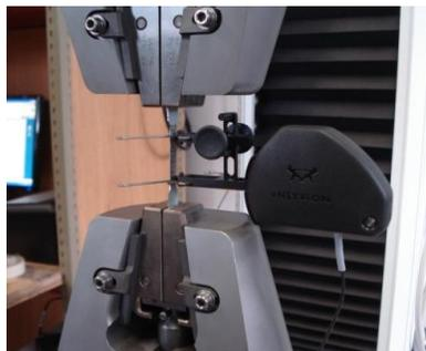
Figura 12. Disposición de la probeta y del extensómetro.
