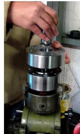
Figura 9. Matriz y punzón hemisférico utilizados para realizar los ensayos de estirado.
