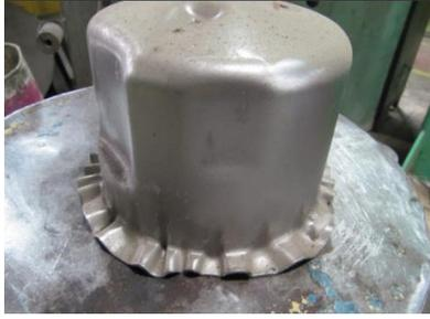
*Figura 45. Defecto de arrugado en la pestaña de una pieza embutida.*
