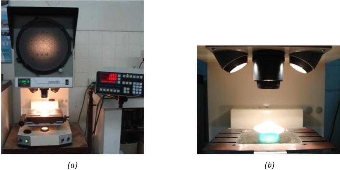
*Figura 43. (a) Proyector óptico de perfiles, (b) Ubicación del conjunto soporte-muestra sobre la mesa de coordenadas del proyector. Sistemas de iluminación activos.*
