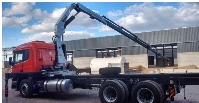
Fig. 2-5. Montaje tras la cabina
