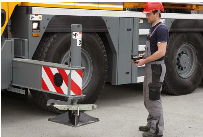
Fig. 2-3. Despliegue de estabilizadores
