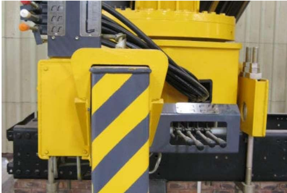
Fig. 6-4. Fijación de la plataforma al chasis.
