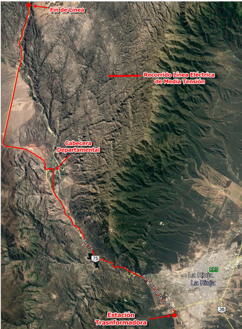
Recorrido de línea de media tensión 13.2kv desde la estación transformadora hasta el centro de consumo
