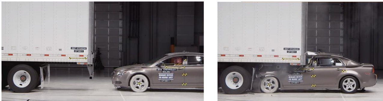
Figura N° 5.9: Paragolpes trasero sin soporte de protección.
