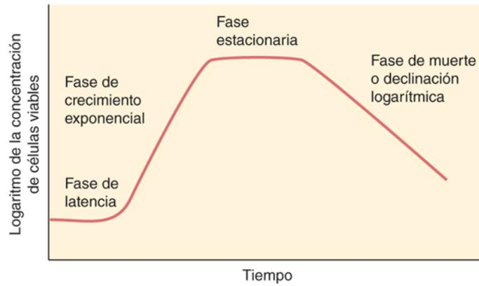
**Figura 16**– Curva típica de crecimiento celular en sistema batch.
