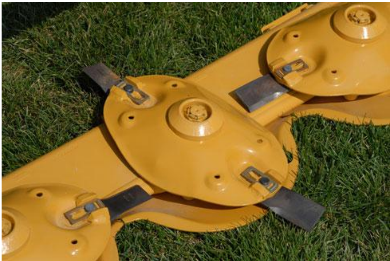
Figura 1.13 - Sentido de giro de discos y respectivas cuchillas
