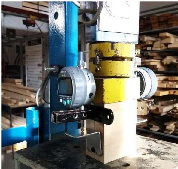
**Figura 3.24:** Ilustración del ensayo en compresión paralela
