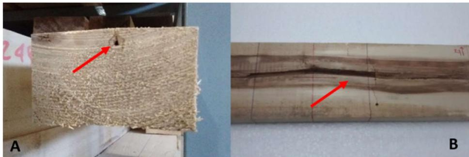
**Figura 3.3:** Identificación de la médula en una sección extrema y en una cara lateral
