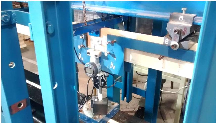
**Figura 3.20:** Vista lateral del dispositivo para medir las deformaciones correspondientes al módulo de elasticidad local y detalle del ingreso de las cargas
