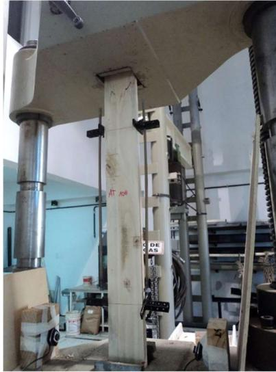
**Figura 3.27:** Ilustración del ensayo en tracción paralela
