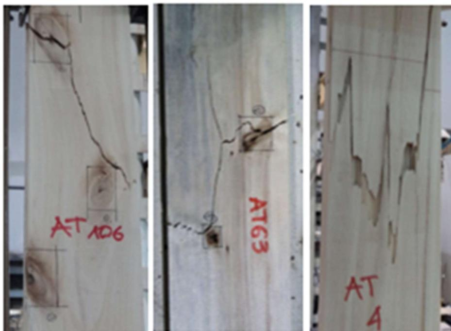
**Figura 4.23** Modo de falla en cuerpos de prueba sometidos a tracción paralela a las fibras
