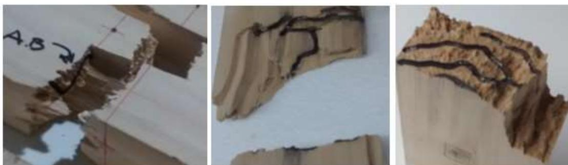
**Figura 4.3:** Secciones de rotura afectadas por ataque del insecto *Megaplatypus mutatus*, a la izquierda grado 2; al centro y la derecha grado 3
