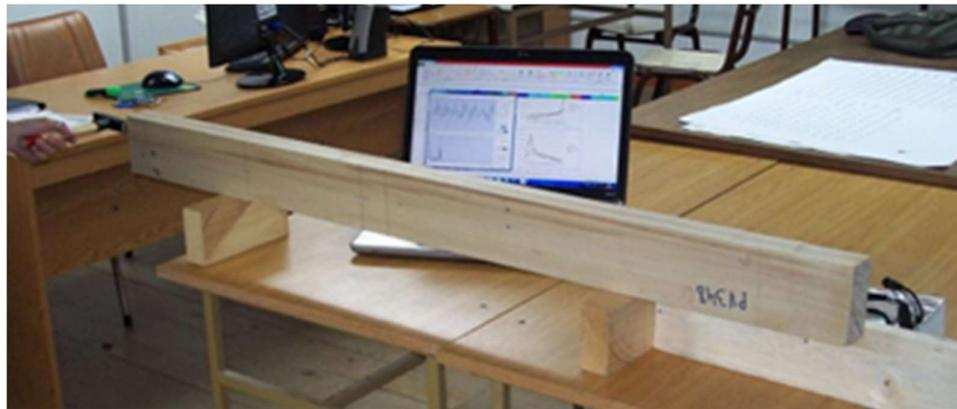
Figura 3.22: Medición de la frecuencia de vibración
