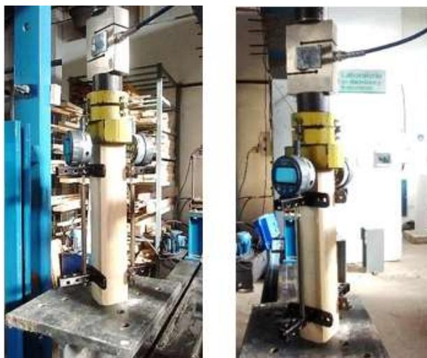
**Figura 3.21:** Vista general del ensayo a compresión paralela a las fibras
