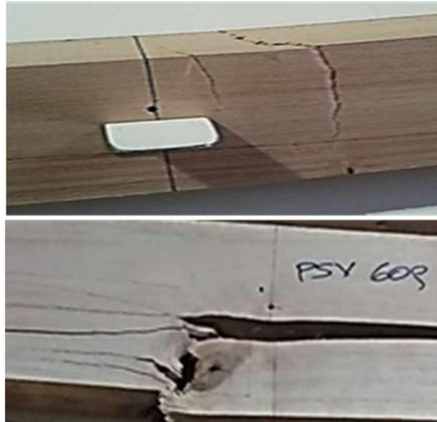
**Figura 4.11:** Modos de falla típicos encontrados en los cuerpos de prueba sometidos a flexión.
