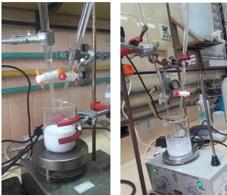
Figura 3. Síntesis de Hidrotalcitas por el método de coprecipitación.
