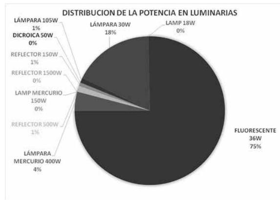
**Figura 2: Tipos de potencias y luminarias utilizadas en sede Tandil.**
