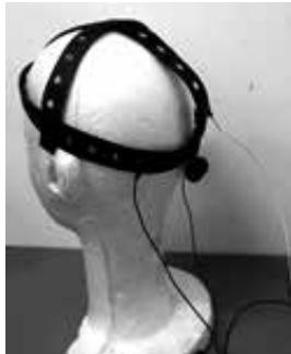
**Figura 4: Vincha para sujeción de electrodos.**
