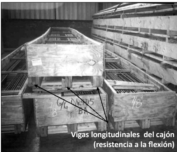
Figura 3. Paquetes de varillas en cajones protectores con vigas longitudinales.
