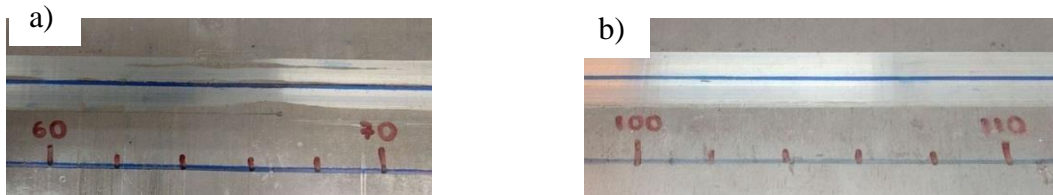
Figura 2: Ampliaciones de: (a) zona "mal" (No Ok) y (b) "bien" soldadas (Ok).
