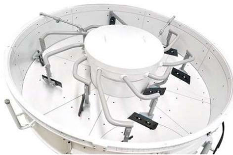
(c) Mezcladora de turbina.
