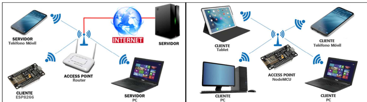
FIGURA 46: MODOS DE FUNCIONAMIENTO ESP8266 (5)
