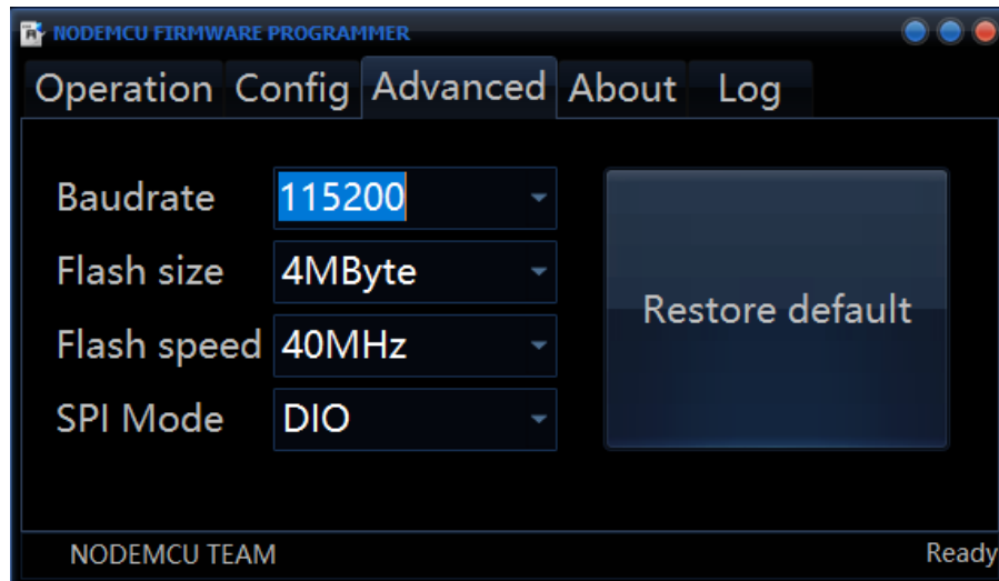
FIGURA 48: CAPTURA DEL SOFTWARE PARA CAMBIAR FIRMWARE DE ESP8266
