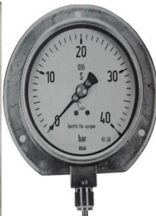
El manómetro puede ser de 0 a 25 o 40 bar, las roscas comúnmente utilizadas son de  $\frac{1}{4}$  o  $\frac{1}{2}$  BSP y el tamaño puede ser de 4 o 5 pulgadas.
