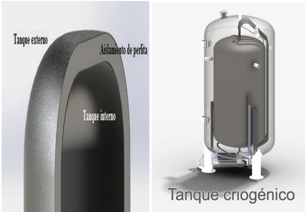
Las protecciones del tanque interno son: dos válvulas de seguridad (S1, S1'), dos discos de ruptura inversa y una línea de purga de gas (V6). El tanque externo se construye en acero al carbono y se encarga de soportar y proteger al tanque interno. Entre la cavidad del tanque interno y externo se encuentra el aislamiento térmico de perlita compacta, la cual reduce la transferencia de calor por conducción.
