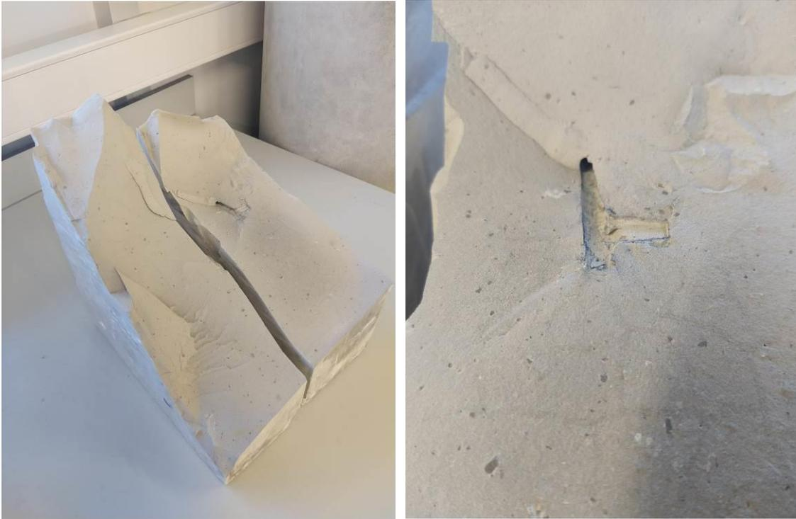
Fig. 11(a) a la izquierda, plano de fractura. Fig. 11(b) a la derecha, tinte azul alrededor del orificio del caño.
