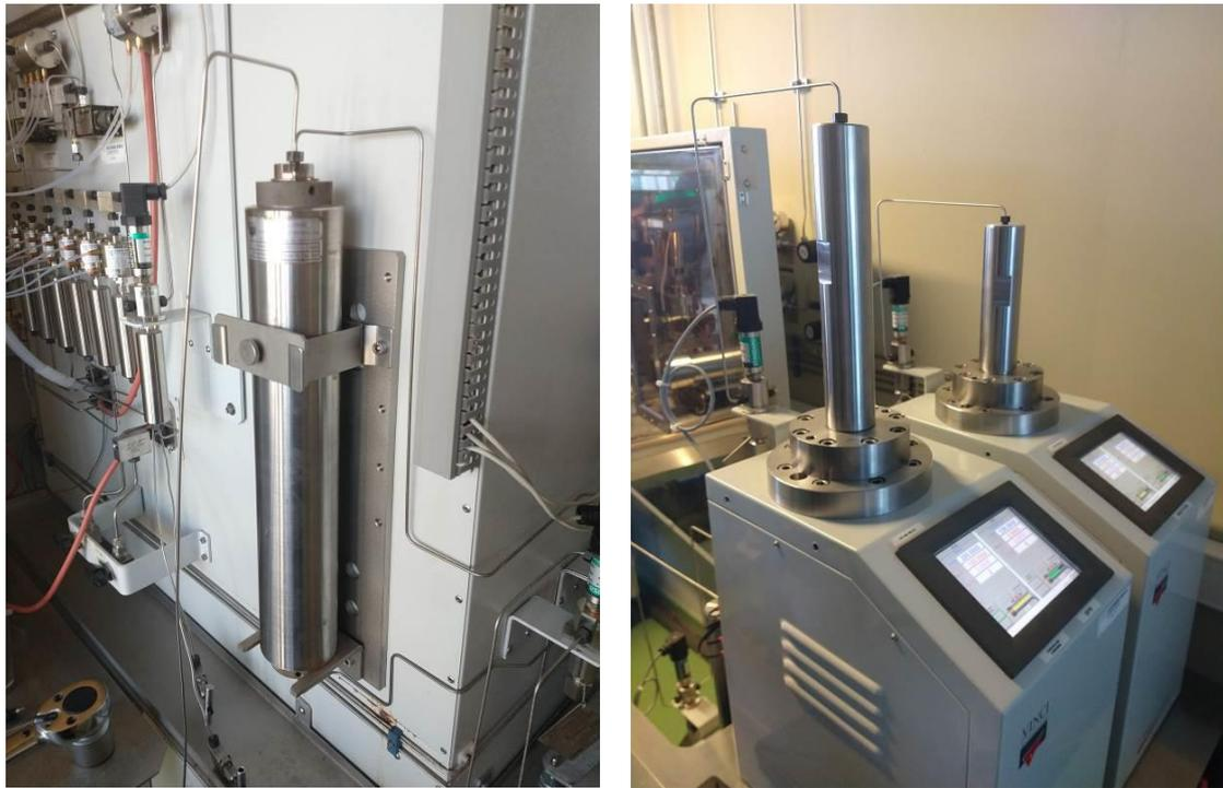
Fig. 7(a) a la izquierda, embolo inyector del fluido de fractura. Fig. 7(b) a la derecha, bomba con control de caudal.
