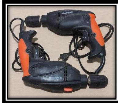
**Descripción:** El taladro portátil es una herramienta que se utiliza fundamentalmente para hacer orificios, su uso se encuentra ampliamente extendido en diversos sectores de actividad, siendo poco frecuentes y de escasa gravedad los accidentes que se derivan de su manipulación. Los accidentes que se producen por la manipulación de este tipo de herramientas tienen su origen en el bloqueo, rotura de la broca e inadecuada manipulación.
