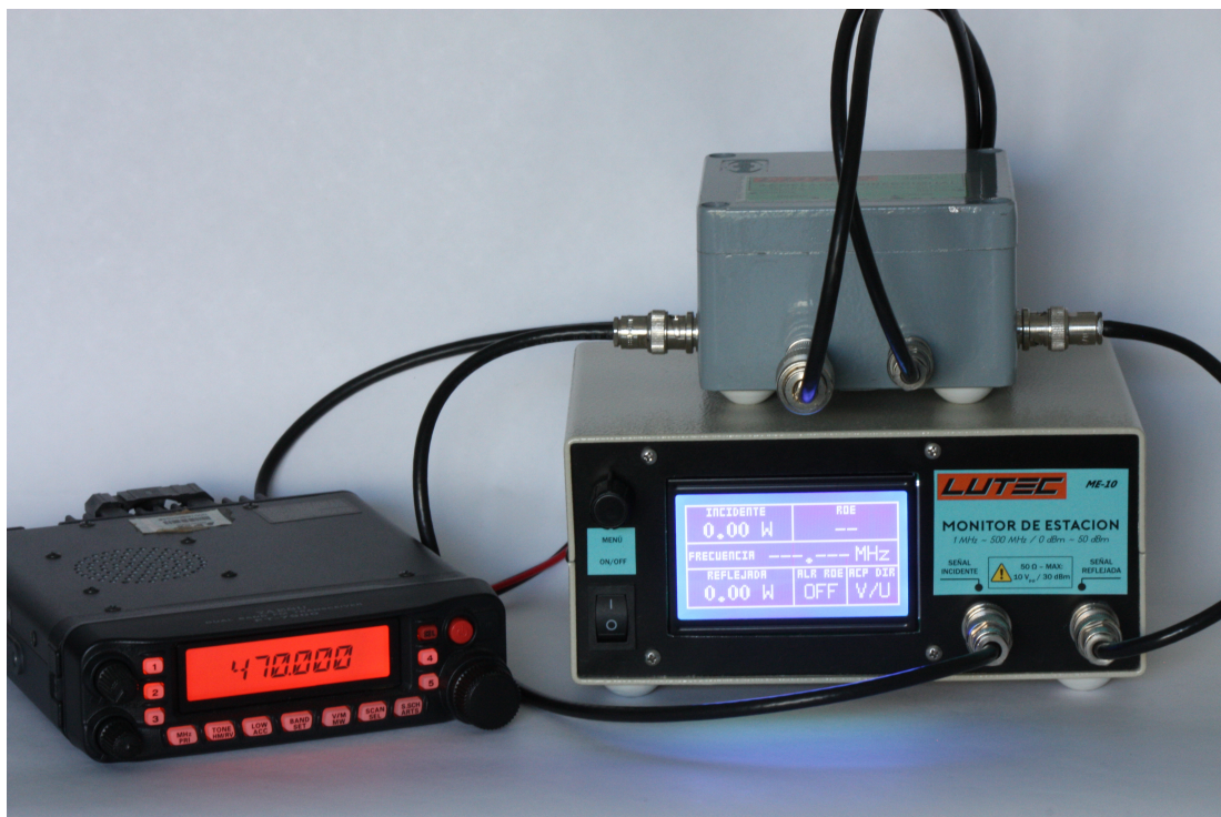
Figura 102: monitor de estación analizando un transceptor de 70 cm
