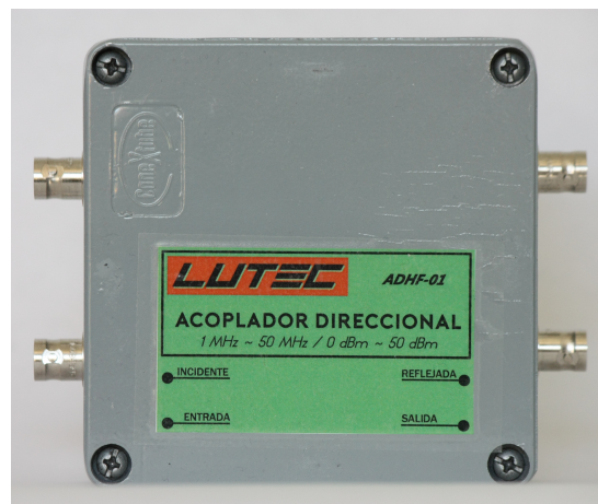
Figura 46: acoplador direccional en tándem terminado
