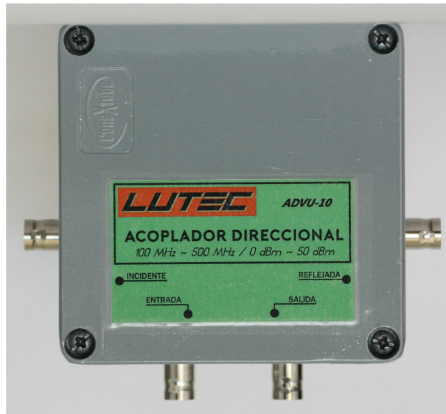
Figura 27: acoplador direccional terminado
