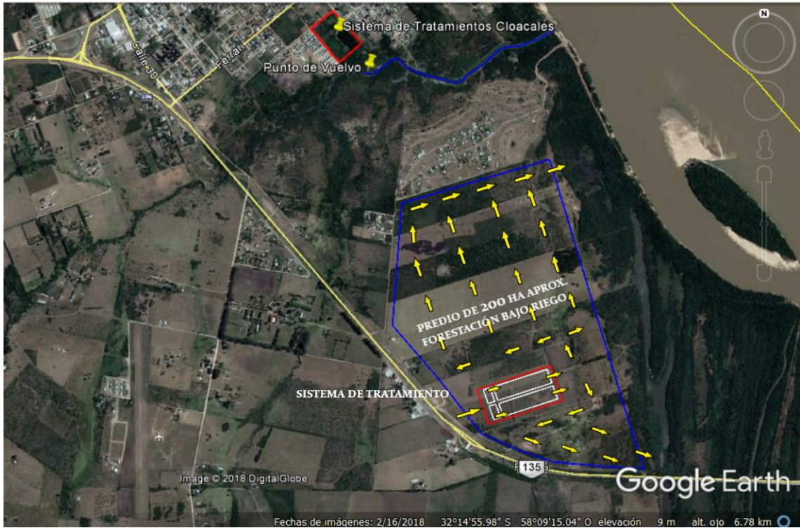
Figura 8: Imagen Satelital Predio desarrollo de Proyecto, ubicación Lagunas de Estabilización, Esquema riego de forestación.
