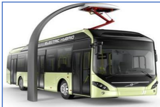
Imagen 3: Sistema de recarga en paradas (Volvo)
