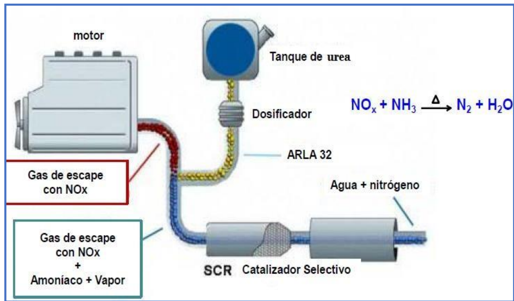
Gráfico 5: funcionamiento de la incorporación de urea al sistema (adaptado de Elcio Luiz Farah Paulo Henrique Demarchi)
