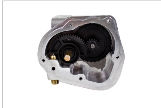
Figura 2: Engranajes reductores del cuerpo de mariposa
