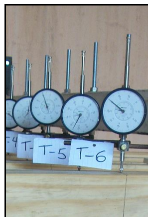
Figura 2. Medición de la deformación vertical
