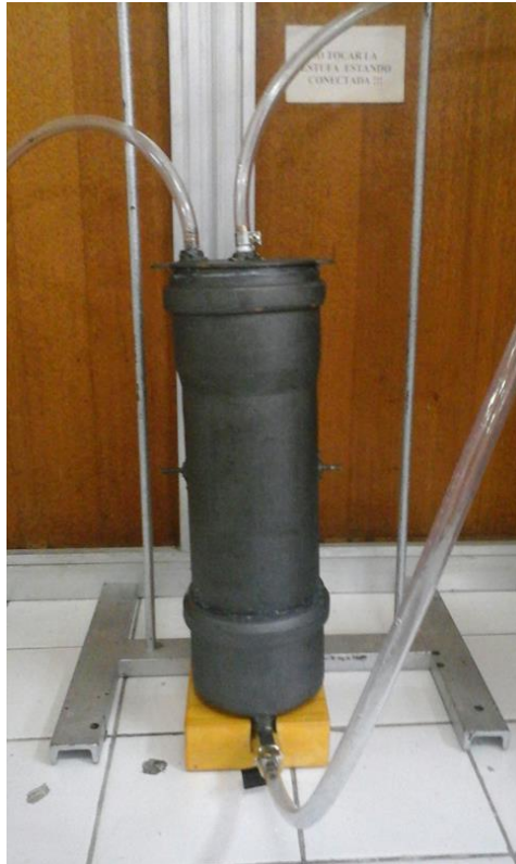
Figura 11: Electrolizador alcalino construido en EnAITecS
