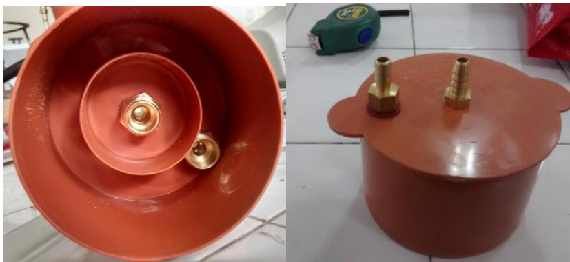
Figura 12: Tapa del electrolizador con los conectores para salida de los gases H 2 y O 2
