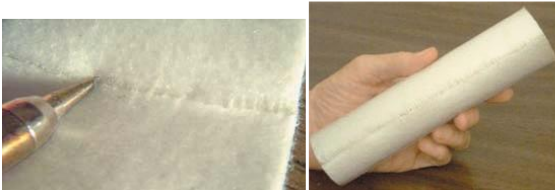
Figura 14: Filtro geotextil separador de gases
