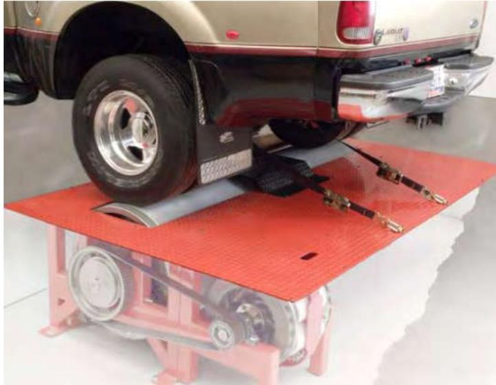
**Imagen xx:** *vista esquemática de un banco de rodillos con dinamómetro de corrientes de Foucault, ensayando una pick-up a propulsión.*
