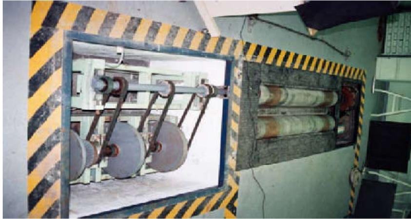
***Imagen xx:** podemos ver un banco de dos rodillos y el acoplamiento a los discos inerciales. Vemos que se usan correas, aunque ello no se recomienda porque puede llegar a patinar la correa en la polea generando inconvenientes en la medición.*
