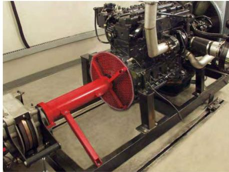
**Imagen xx:** *imagen representativa de un motor de combustion interna acoplado a un banco de ensayo de motores.*
