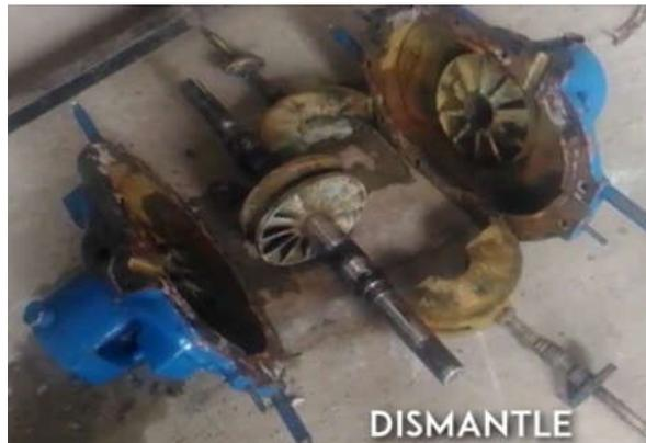
**Imagen xx:** *despiece de dinamometro hidráulico 50 hp @1500 rpm. En el centro se encuentra el rotor y adosado a la estructura se encuentra los alabes estáticos que recibirán el choque de las partículas.*
