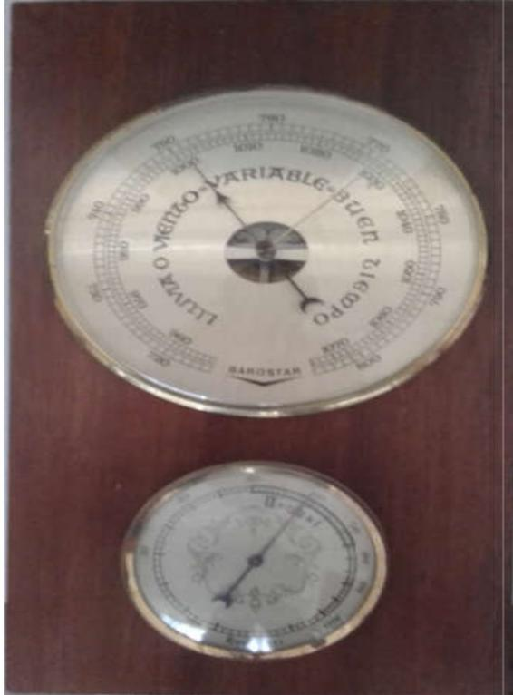
**Imagen xx:** En la parte superior vemos un medidor de presión ( para este caso está indicando 1010 hPa) y el instrumento de abajo indica un 59% de humedad relativa.
