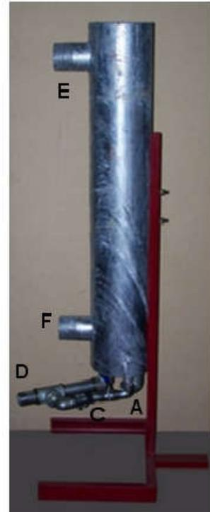
**Imagen xx:** sistema de refrigeración del agua del motor.
