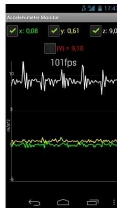
Figura 2. Registro de aceleraciones con el acelerómetro de un celular.
