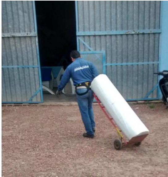
Personal descargando Fibra de Vidrio Matt 450 o 300, lo que significa que gramaje es de 300 o 450gr/m 2 . Presentación en rollos de 52kg aproximadamente, ancho del rollo 1,40m.
