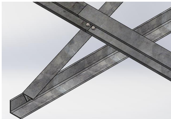
Ilustración 30 – Prolongación de perfiles C y sujeción a los perfiles ángulo
