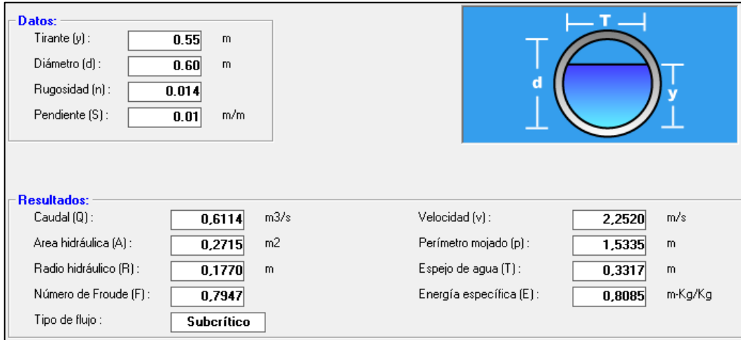
Figura 5-13 Calculo de red de derivación
