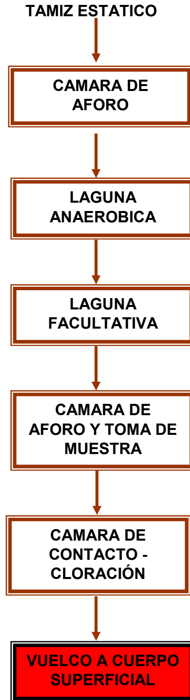
Imagen 23: Sistema secundario del tratamiento de efluentes Líquidos.
