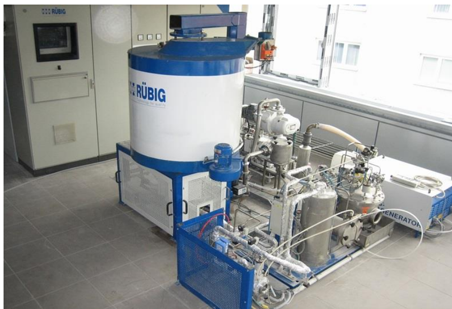
Figura 3-1. Equipo PA-CVD de Rübige GmbH & Co KG disponible en el departamento de materiales de la FH-OOE.
