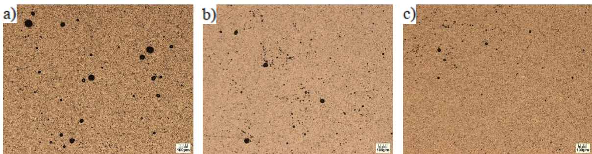
Figura 4-2. Micrográficas de muestras del ensayo G sobre AISI 4140 en diferentes posiciones en el interior de la cámara. (a) Horizontal, (b) Vertical y (c) Boca abajo.
