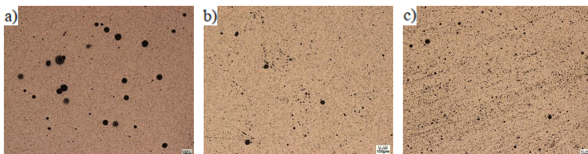
Figura 4-4. Micrografías de muestras de AISI 4140 en posición vertical, variando la temperatura de proceso. (a) 400°C, (b) 450°C y (c) 550°C.
