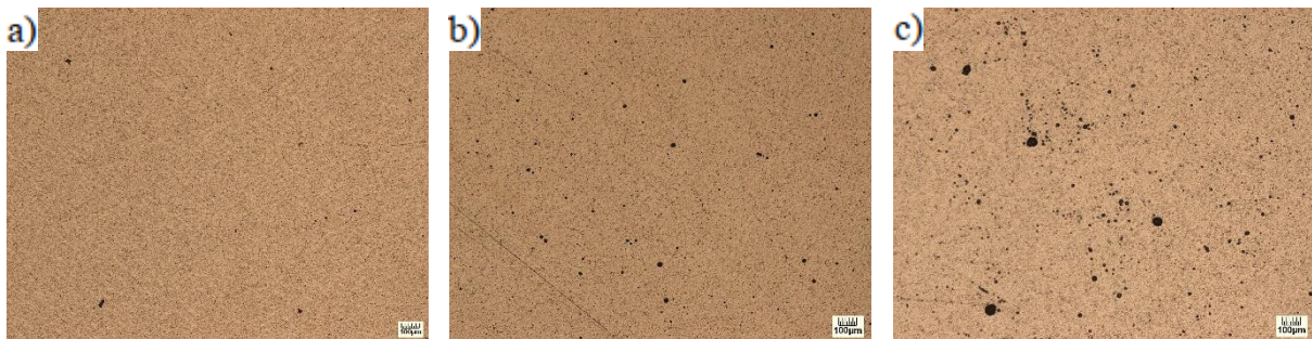
Figura 4-6. Micrografías de muestras de AISI 4140 recubiertas con diferentes espesores de película (a) 4 µm, (b) 20 µm y (c) 40 µm.
