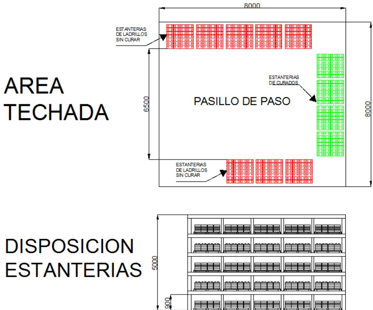
Figura N° 17: Esquema depósito de bloques terminados
