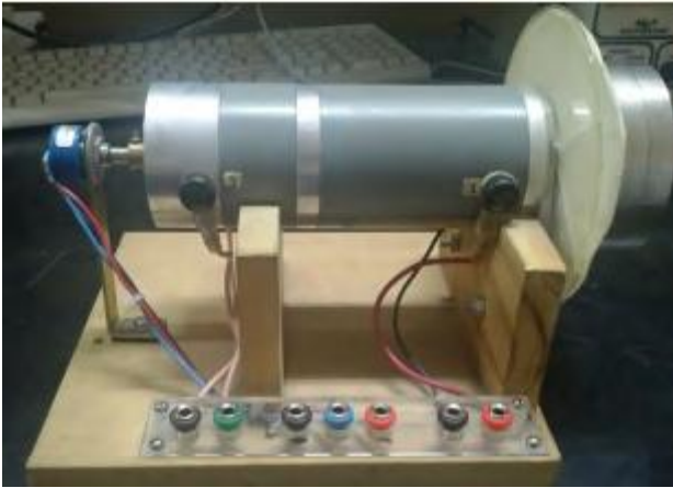
Fig. 2. Sistema motor-volante-sensor de posición
