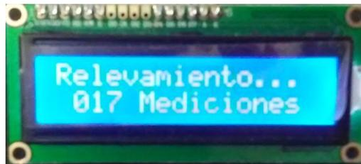
Fig. 85 - Display LCD. Equipo realizando un relevamiento automatico
