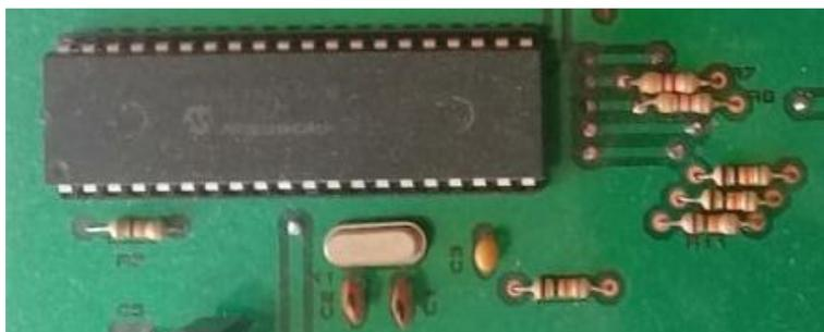
Fig. 48 - Fotografía microcontrolador en PCB
