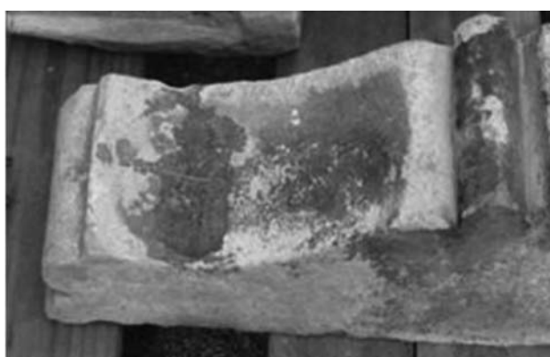
Figura 30: Ornamento de arenisca luego del crioarenado a 3.5 bar.
