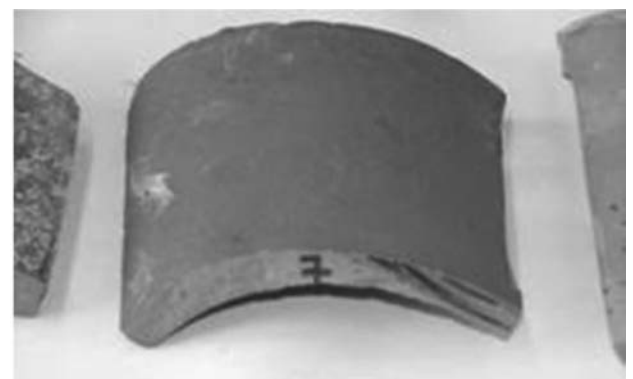
Figura 25: Teja de 60 años luego del crioreinado a 1.5 bar.
