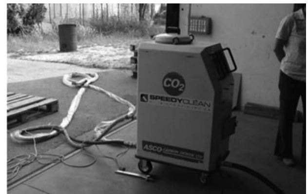
Figura 14: Equipo de crioreinado. Se observa el tanque de reserva de CO 2 congelado y granulado.
