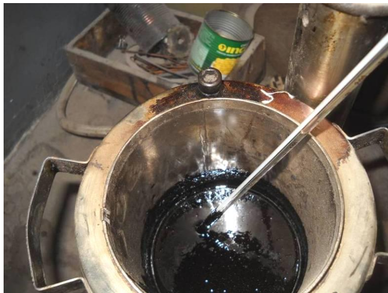
Figura 1. Recipiente termostatzado con muestra de asfalto base
