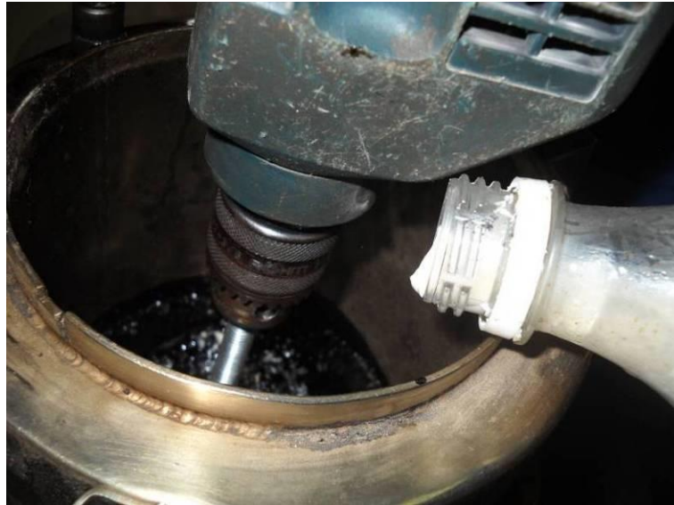
Figura 6. Aditivación de la emulsión de SBR
