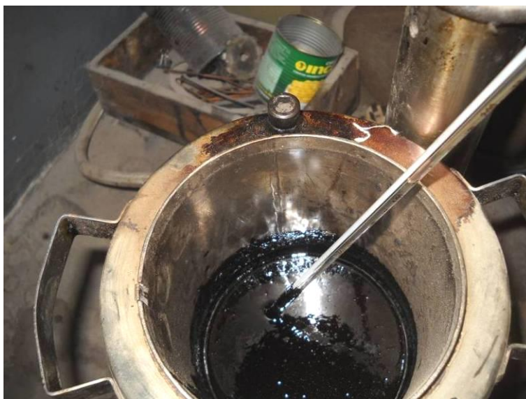
Figura 1. Recipiente termostatzado con muestra de asfalto base
