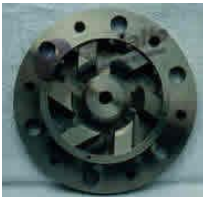
Figura 2. Cabezal con sistema rotor-estator.
