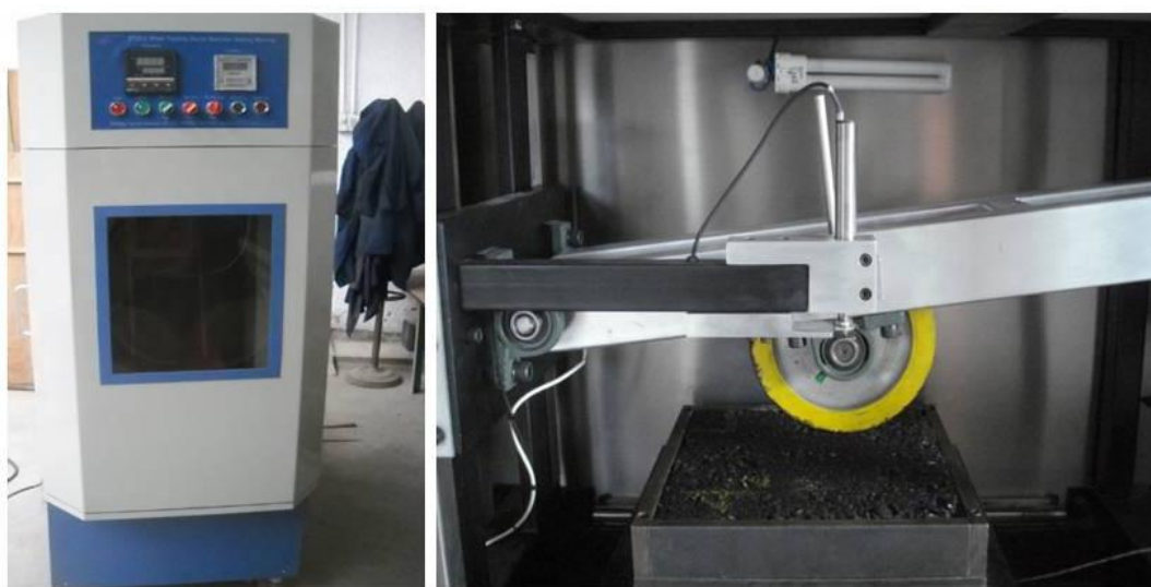
Figura 7. Vista de compactador Roler Compact y ensayo de WTT de las muestras
