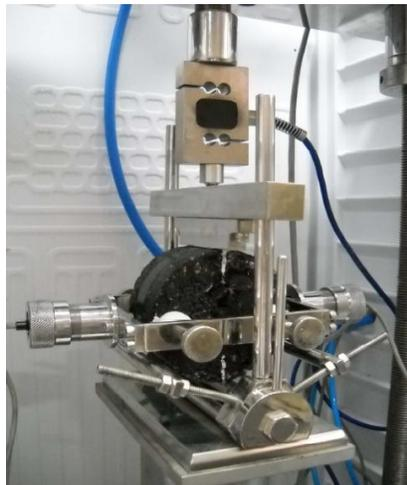
Figura 1. Ensayo de Módulo Dinámico por Tracción Indirecta
