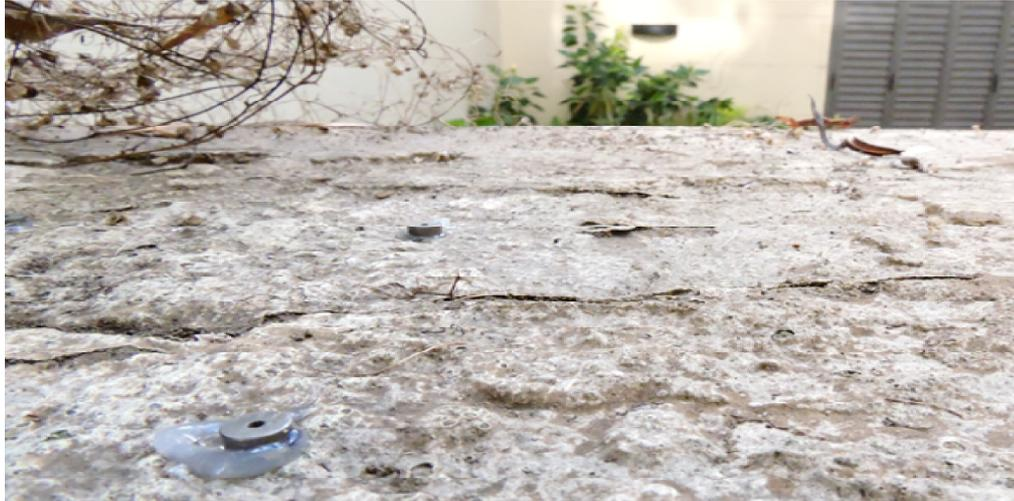
Imagen 3. Posición final de topes alrededor de la fisura.
