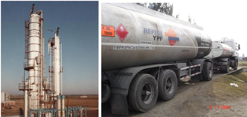
Foto 1. Destilación y traslado del asfalto a la planta asfáltica
