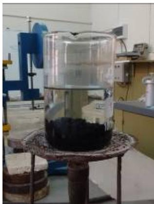
Imagen 3. Ensayo del Test del Hervido
