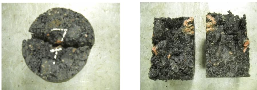
Imagen 1 y 2. Vista de las probetas luego del ensayo a tracción indirecta
