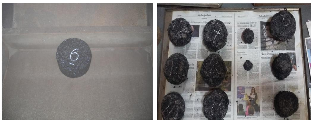
Imagen 5 y 6. Probeta a ensayar dentro del tambor. Probetas ensayadas
