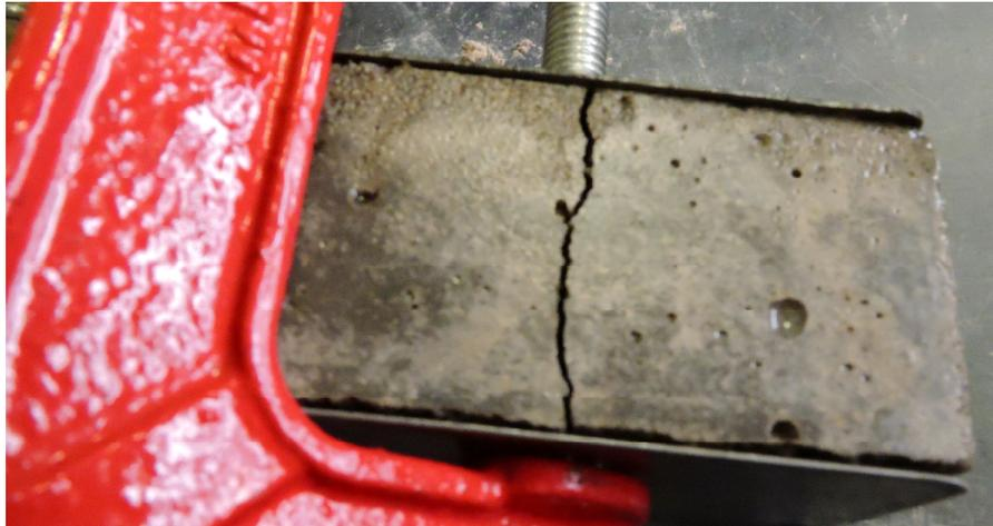
Imagen 1. Vista lateral de la rotura provocada por bentonita.
