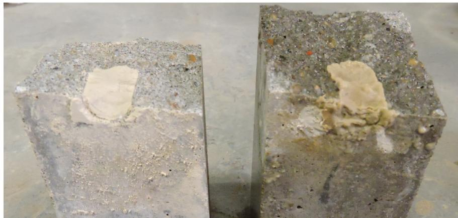
Imagen 2. Secciones de la probeta para una mejor apreciación de la rotura.
