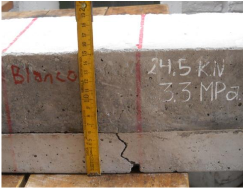
Figura 13 Ensayo de vigas de control.
