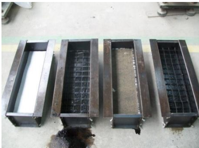
Figura 3. Colocación de materiales Geosintéticos.
