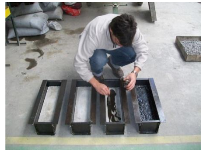
Figura 2. Aplicación de la emulsión asfáltica sobre base de hormigón pobre.
