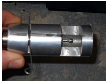
Figura 6. LVDT \pm 5,00 mm y soporte
