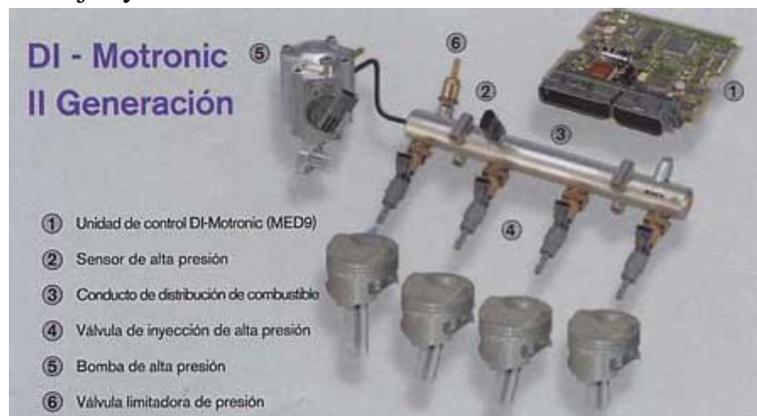
**Figura 87:** Sistema DI- Motronic segunda generación.
