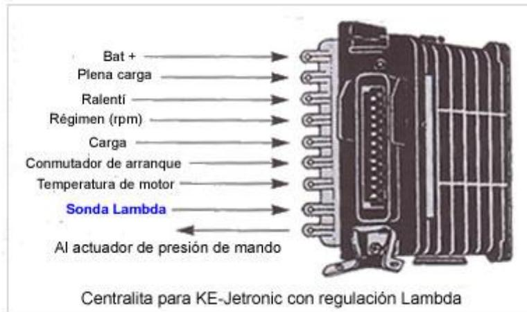
**Figura 58:** Centralita para KE-Jetronic con regulación Lambda.
