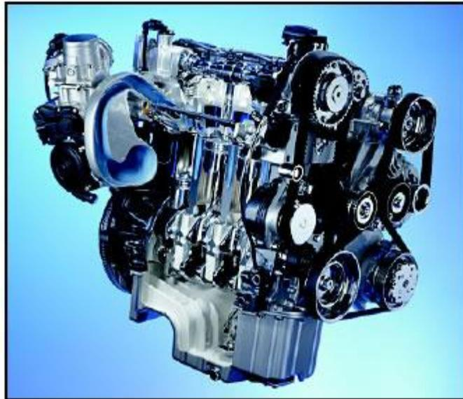
**Figura 86:** Corte de motor con tecnología de Inyección Bosch.
